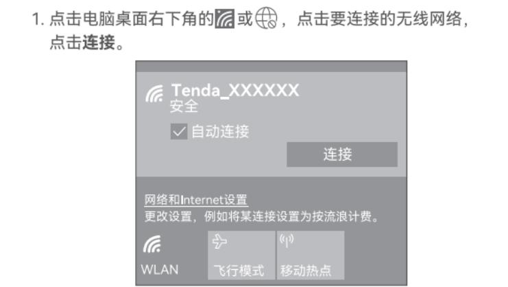
等待网卡初始化完成，安装成功。您可以连接Wi-Fi了。
